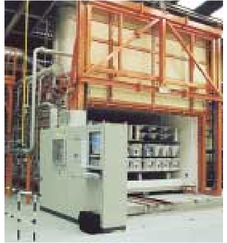
Four à sole mobile (société Keramischer Ofenbau)
